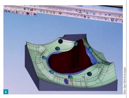
definieren. "Mit von uns erstellten Makros errechnet hyperMill in der Regel automatisch das passende NC-Programm", erklärt Biesinger. "Ob Passung, Gewinde oder Flachsenkung – die Bohrung erhält dank der Makros alle in der Konstruktion festgelegten Attribute.
