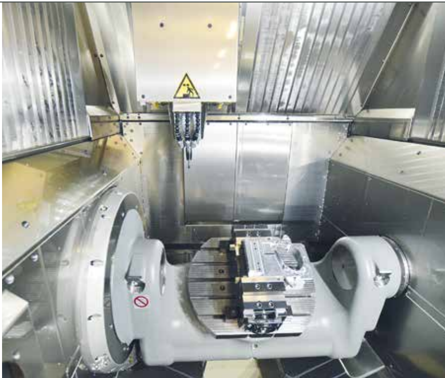
Schwenkrundtisch: gut zugänglich und mit einem Durchmesser von 450 mm bereit für große Werkstücke. (Bild: Schröder)
