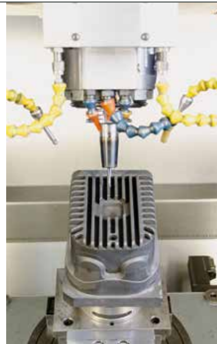
Elektrodenfertigung: Blick in die Hermle C30, die mit ihrer Grafitabsaugung bestens für die Elektrodenherstellung geeignet ist.
